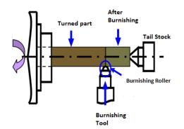
FIGURE 1. SCHEMATIC REPRESENTATION OF BURNISHING PROCESS.
