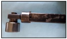
FIGURE 3. CARBIDE BURNISHING TOOL
