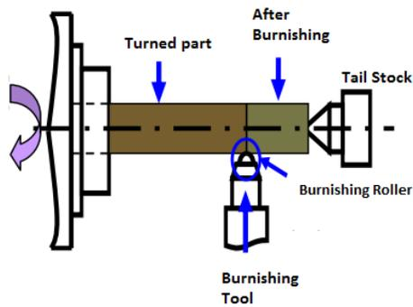
FIGURE 1. SCHEMATIC REPRESENTATION OF BURNISHING PROCESS.
