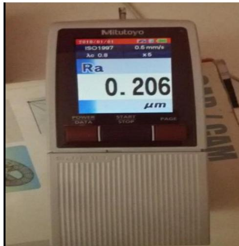
FIGURE 5. SURFACE ROUGHNESS TESTER
