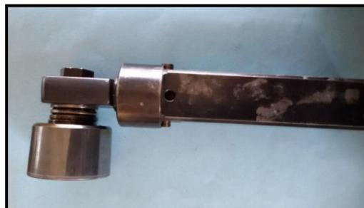
FIGURE 3. CARBIDE BURNISHING TOOL
