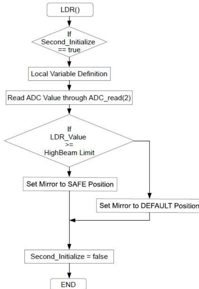
Figure 12. FIRMWARE'S LDR FUNCTION
