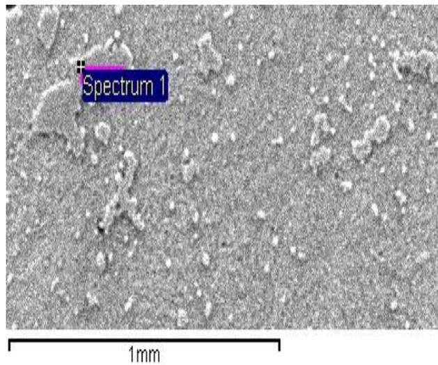
**FIGURE 6:** CARBIDE EDS ANALYSIS IN GRADE AISI 440C
